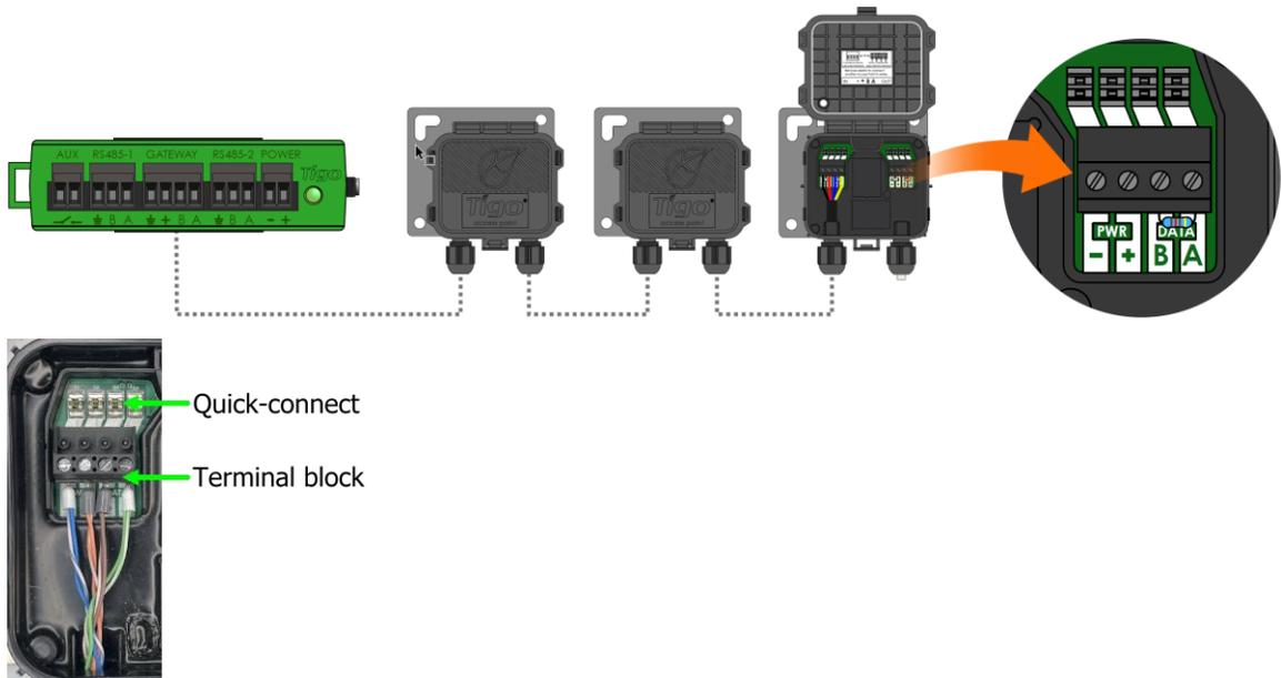
3. Beim Anschluss an einen anderen TAP verwenden Sie die Terminals auf der rechten Seite, nachdem Sie den vorinstallierten 120Ω-Abschlusswiderstand entfernt haben.
