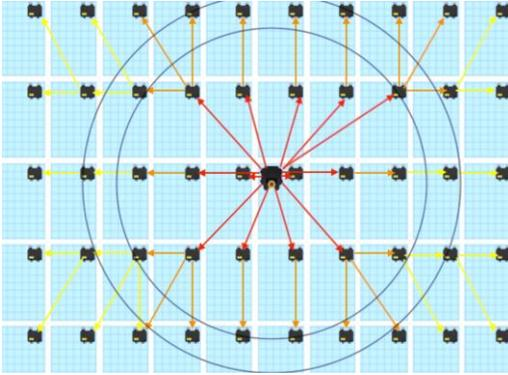
Stellen Sie sicher, dass es keine Hindernisse gibt, die das TAP-Signal zu anderen TS4-Einheiten im Array stören könnten. Wenn das Array mehrere Dachebenen hat, müssen Sie möglicherweise mehrere TAPs installieren. Weitere Informationen finden Sie im Hilfe-Center-Artikel [TAP-Platzierung und Layout](#).
