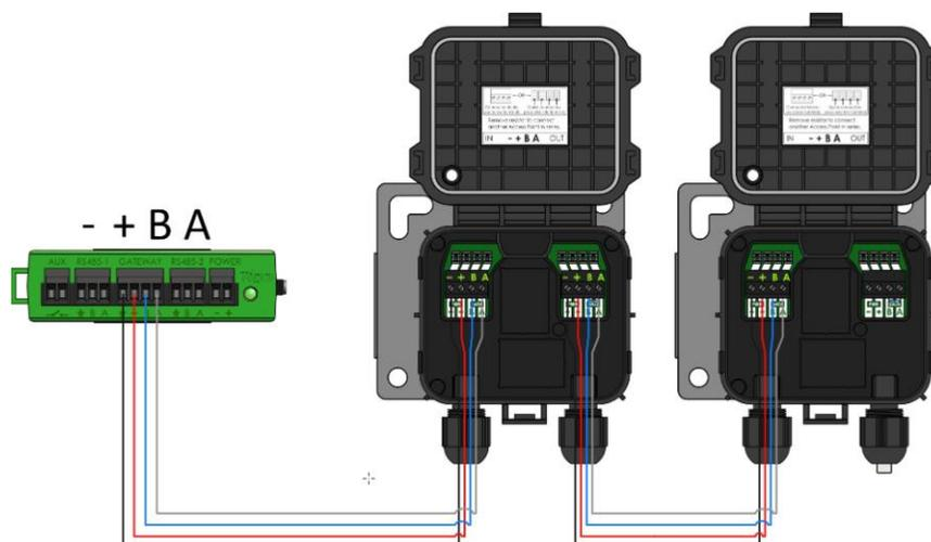
3. Falls verwendet, verbinden Sie alle Geräte von Drittanbietern, die Modbus verwenden, mit den Terminals RS-485 1 und RS-485 2:
